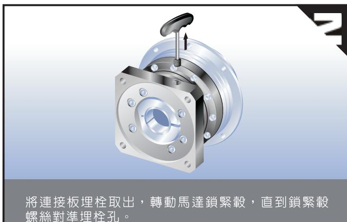
將連接板埋栓取出，轉動馬達鎖緊轂，直到鎖緊轂螺絲對準埋栓孔。
