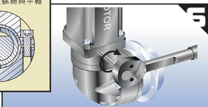
將馬達與減速機直立擺設，參照表二建議之扭力值，以扭力板手將馬達鎖緊轂螺絲鎖緊。
